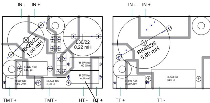
hier kann ein zusätzlicher Widerstand von 10 Ohm bestückt werden um den HT Pegel um ca. 1.5 dB abzusenken
